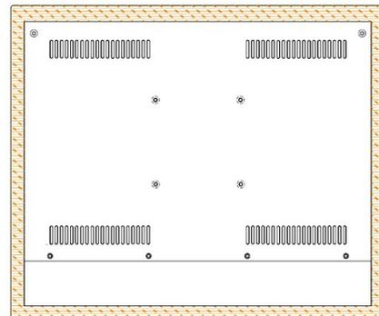
Durch Aufbringen einer Zellkautschukdichtung (Stärke 2mm) im rückseitigen Randbereich des Panels (rot schraffiert) kann nach DIN EN 60529 eine Schutzart IP65 bzw. NEMA 12 zum Schaltschrank hin erreicht werden. Voraussetzung ist ein ordnungsgemäßer Ausschnitt im Schaltschrank ohne Verformungen und eine Mindest-Materialdicke von 1,5mm.
