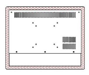
Durch Aufbringen einer Zellkautschukdichtung (Stärke 2mm) im rückseitigen Randbereich des Panels (rot schraffiert) kann nach DIN EN 60529 eine Schutzart IP65 bzw. NEMA 12 zum Schaltschrank hin erreicht werden. Voraussetzung ist ein ordnungsgemäßer Ausschnitt im Schaltschrank ohne Verformungen und eine Mindest-Materialdicke von 1,5mm.
